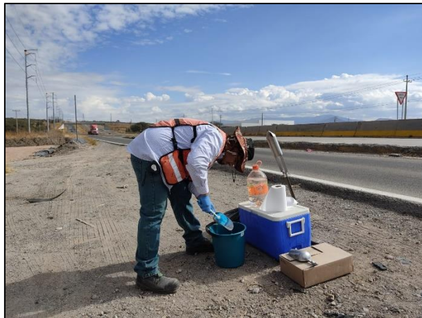
14. El personal encargado de la toma de muestras lavó el equipo utilizado con jabón libre de fosfatos.
