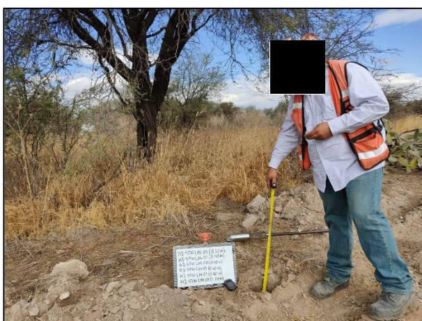
04. Las profundidades de los puntos de muestreo fueron verificadas con apoyo de un flexómetro.
