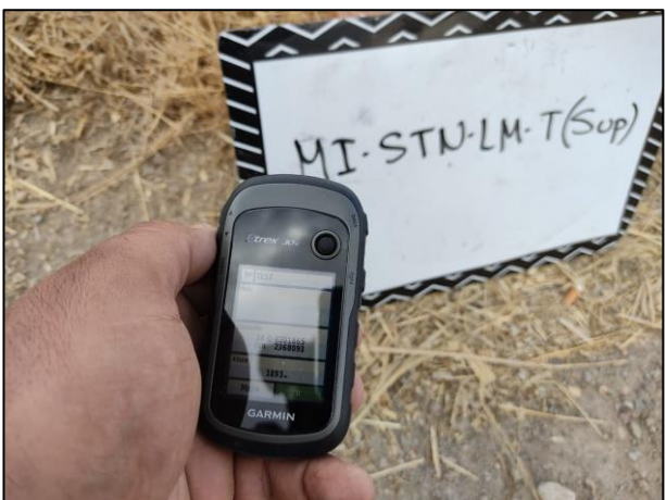
17. Las coordenadas de los puntos de muestreo fueron tomadas con apoyo de un GPS.
