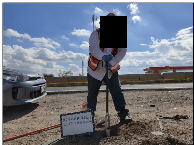
09. Toma de muestra de periferia en el área afectada.
