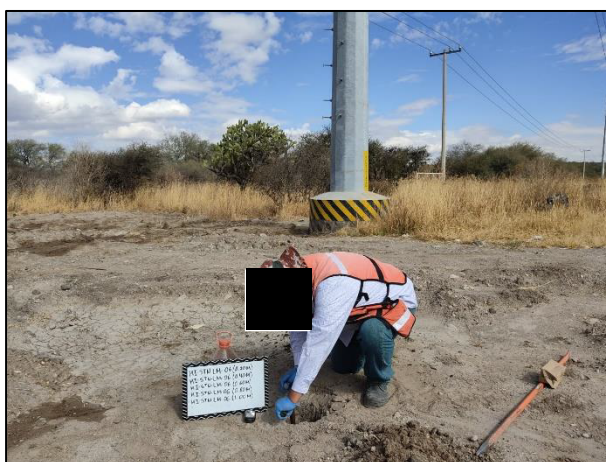
06. Se utilizó Hand Auger de acero inoxidable para la toma de muestras a diferentes profundidades en el área afectada.
