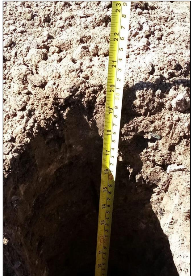
09. Con apoyo de flexómetro se verificaron las profundidades de los pozos de sondeo para conocer la pluma del contaminante.
