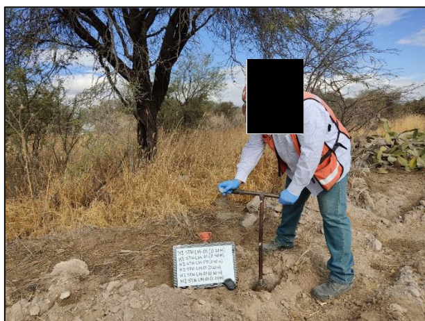
05. Se realizó la toma de muestras de acuerdo con el Plan de Muestreo. Toma de muestra en el área afectada.
