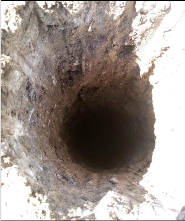
06. El suelo del sitio en estudio presenta textura arenosa en los estratos superficiales (0 a 0.05 m) y textura arcillosa en los estratos siguientes.
