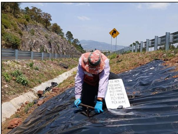
05. Toma de muestras dentro del Área Afectada, con apoyo de Hand Auger
