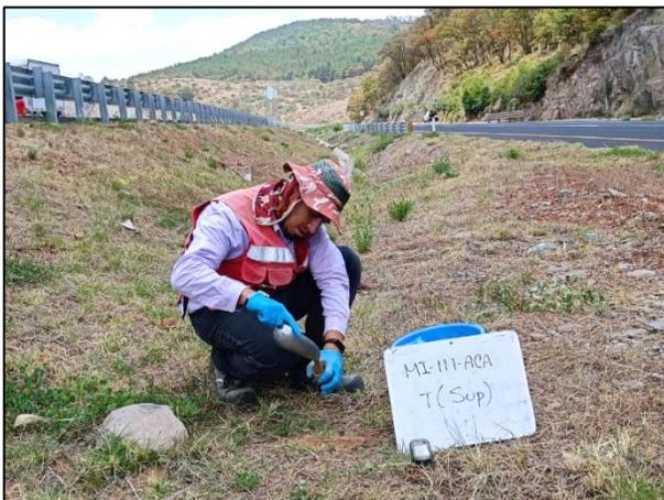
17. Se realizó la toma de la muestra Testigo, con apoyo de un cucharón de acero inoxidable.
