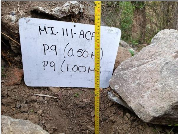
15. Se verificaron las profundidades de los puntos de muestreo con apoyo de un flexómetro.
