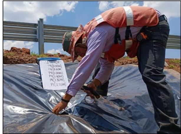
10. Efectuadas la toma de muestras dentro del Área Afectada, las incisiones realizadas fueron debidamente selladas con apoyo de cinta industrial.
