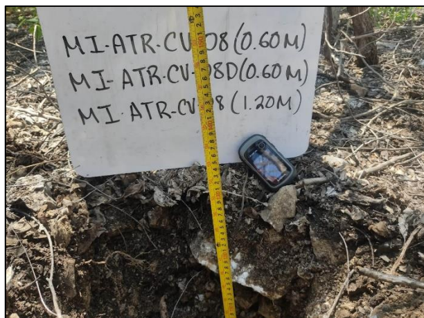
09 - Se realizó la medición de las profundidades en los puntos de muestreo de acuerdo con el plan de muestreo.
