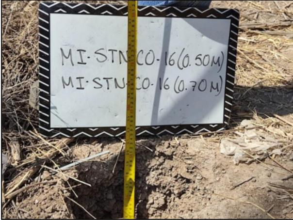
07. Las profundidades de los puntos de muestreo fueron verificadas con apoyo de flexómetro.
