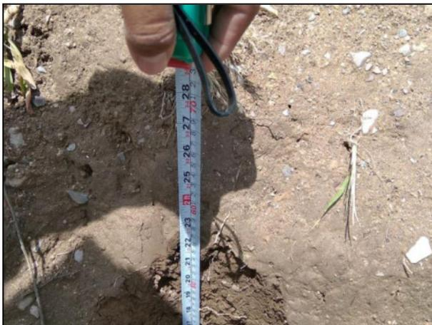
09. Con apoyo de flexómetro se corroboró la infiltración del hidrocarburo.
