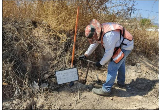
08. Se tomaron muestras en las Periferias de la Fosa de Excavación con apoyo del Hand auger de acero inoxidable.
