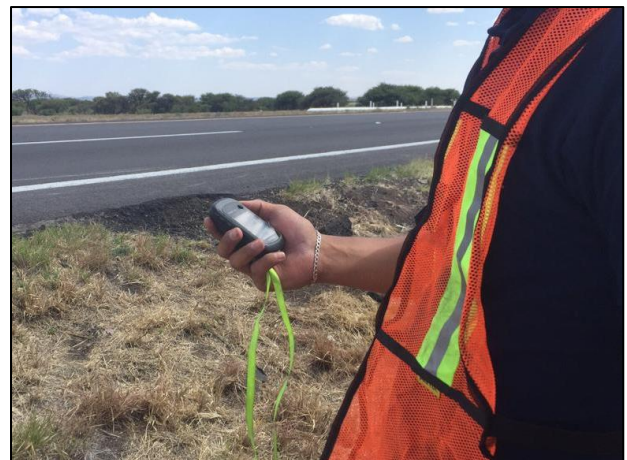
06 - Por medio de GPS se determinaron las coordenadas UTM de los puntos de sondeo, además de los vértices de la Zona afectada.
