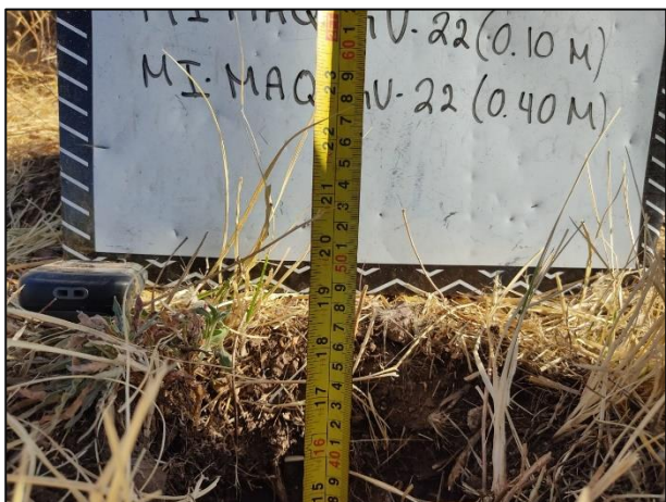
09 - Se realizo la medición de las profundidades en los puntos de muestreo de acuerdo con el plan de muestreo.
