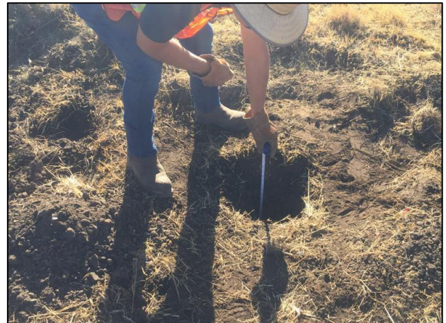
04 - Con apoyo de flexómetro se verificó la profundidad de los puntos de sondeo de la Zona afectada.
