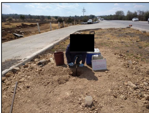
10. Toma de la muestra del relleno de la Fosa de Excavación A.
