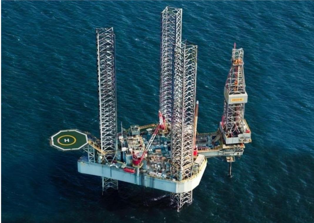
**Imagen RE 1 Ejemplo de Jack up a utilizar en el Proyecto**
