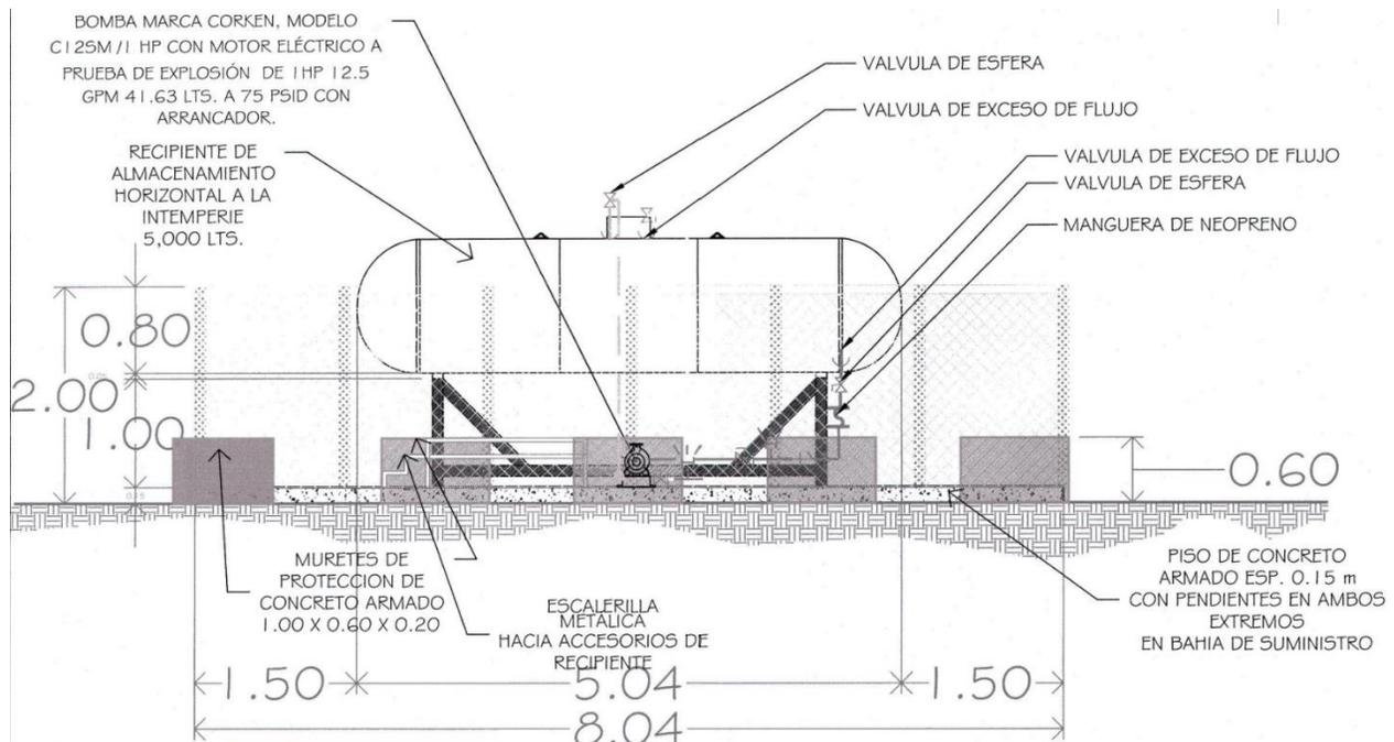
Imagen 9. Vista Longitudinal del Tanque de Almacenamiento.
