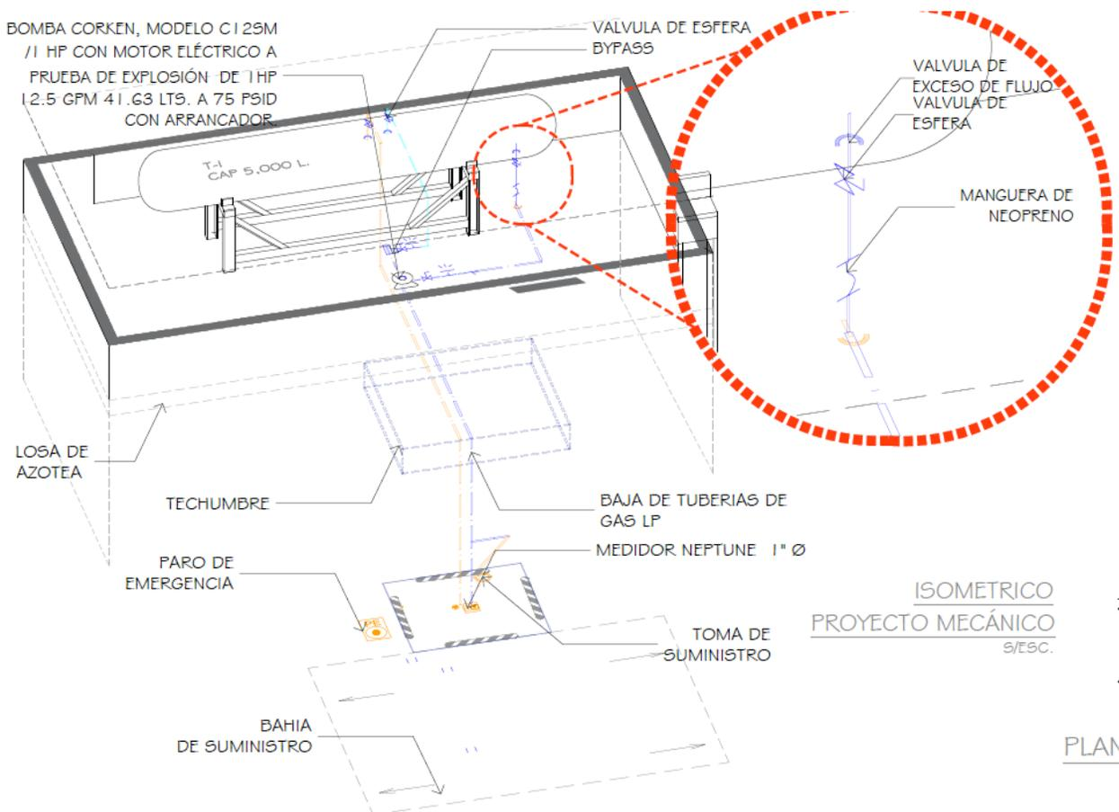
Imagen 8. Isométrico de la Estación de Carburación para gas L.P.
