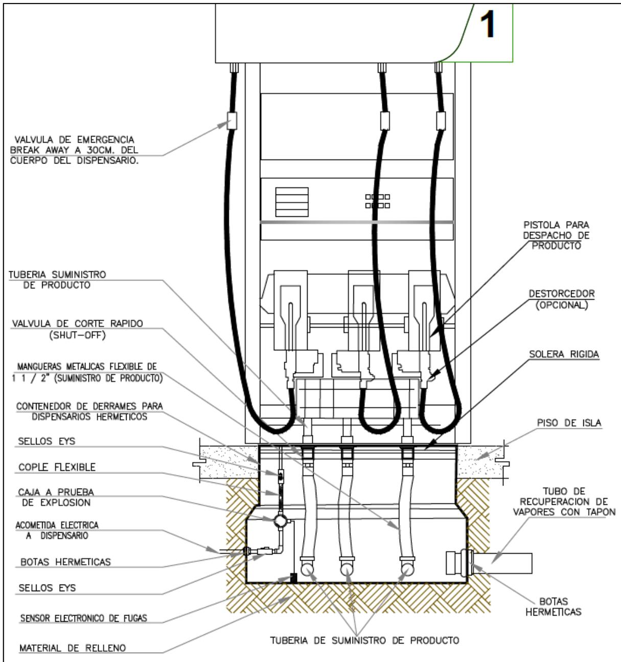
Figura 16. Detalles del sistema recuperador de vapores en los módulos de despacho.
