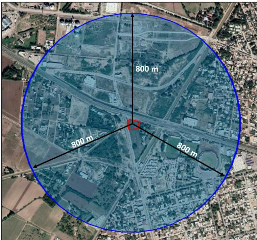
Figura 8. Área de Influencia generada a partir de los tanques de almacenamiento.
