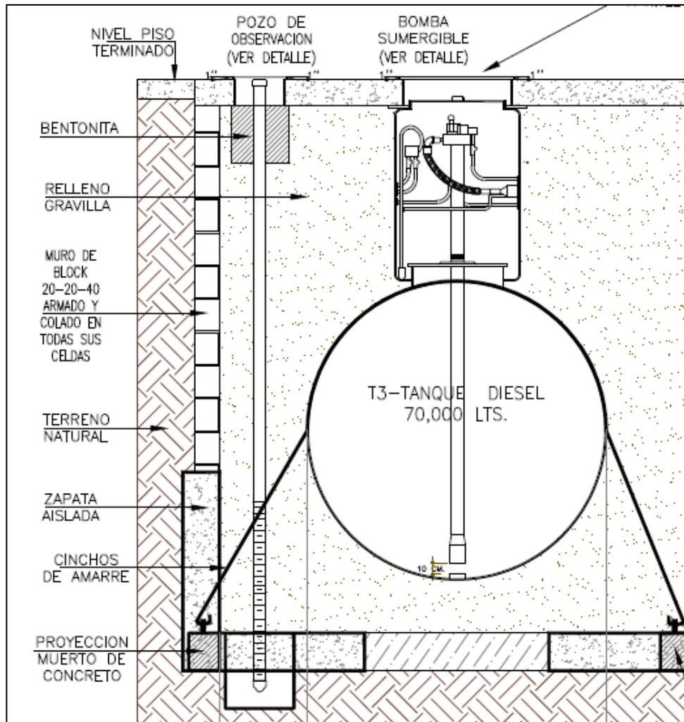
Figura 17. Ubicación de dispositivos en el tanque de almacenamiento.
