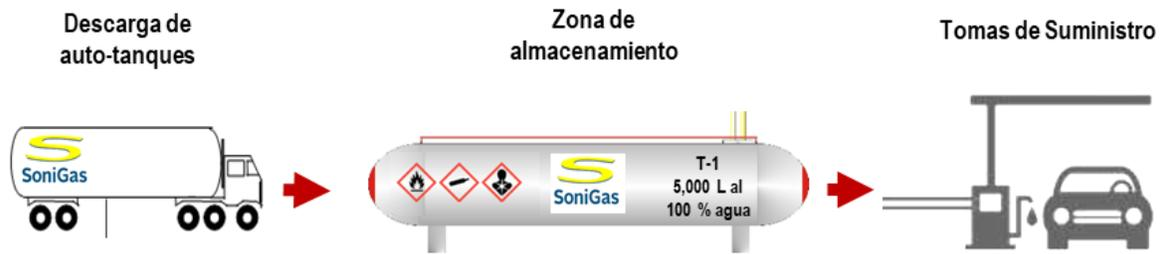
**Figura III.2.** Proceso de operación de la Estación de gas L.P. para carburación, Apaseo 4.
