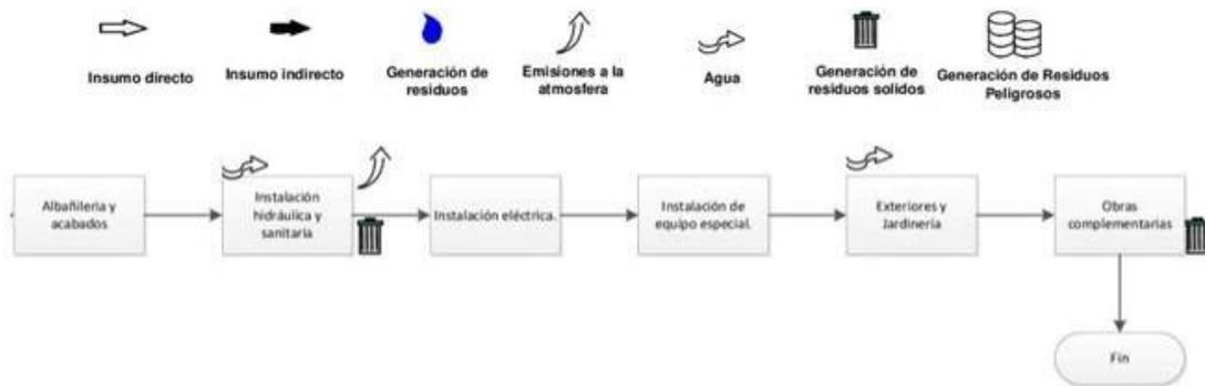
La construcción de obra civil contempla las oficinas administrativas, instalación de tanques de almacenamiento, instalaciones sanitarias, eléctricas; se tiene contemplado realizar obras de albañilería y acabados instalaciones en general obras complementarias y el equipamiento de la estación de servicio. Los residuos y emisiones que se pueden generar durante todas las etapas se describen a continuación.
