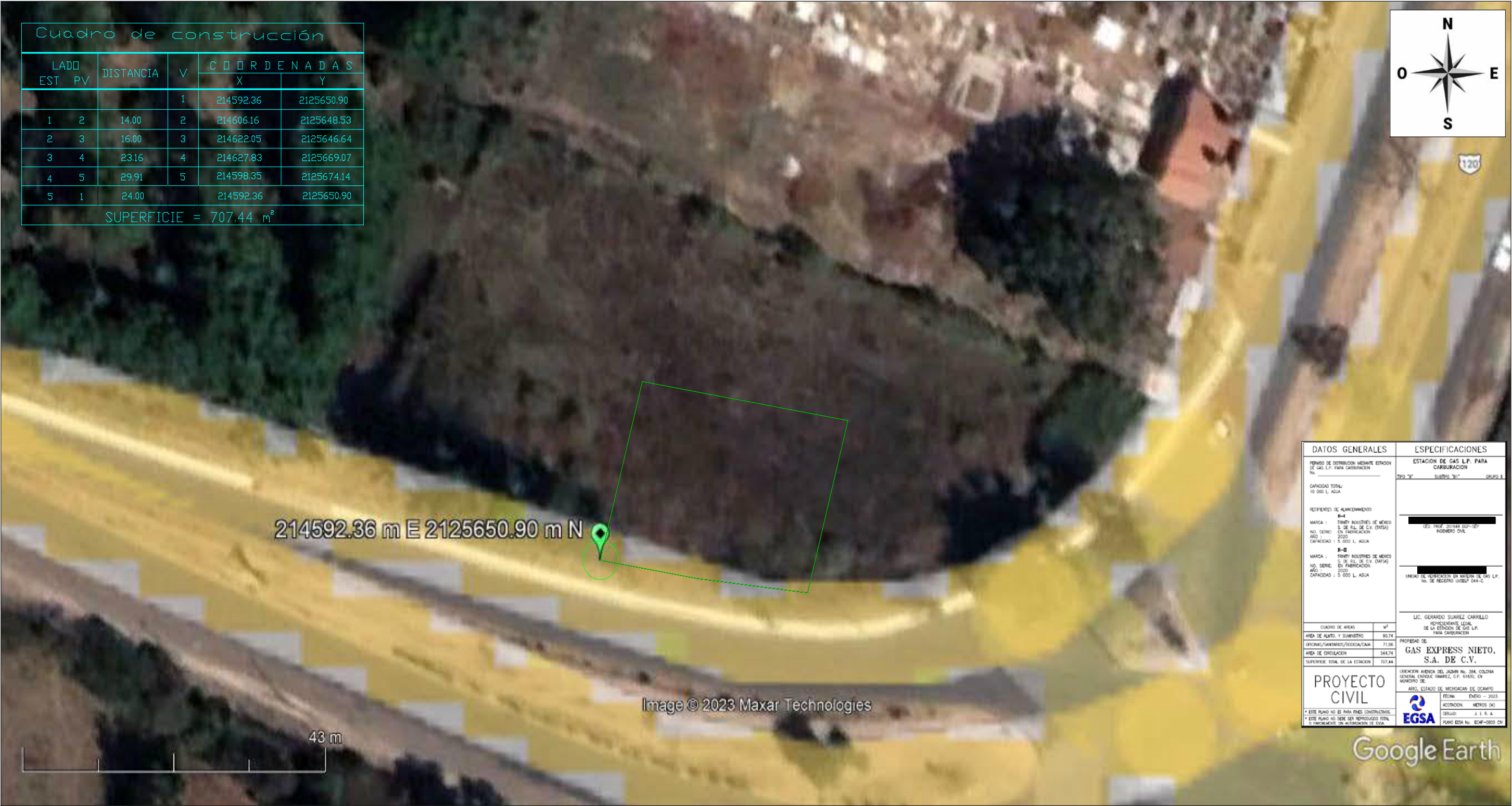
Figura 1. Foto mapa georreferenciado en AutoCAD, con foto satelital escalada 1_100; indicando el polígono para el proyecto de la estación de carburación con sus coordenadas UTM DATUM WGS84.
