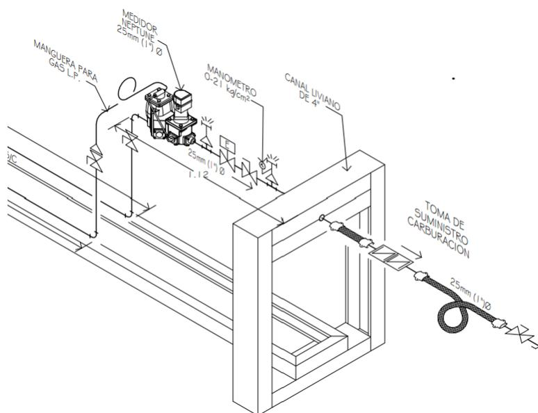
Imagen. Toma de suministro de la Estación de Gas L.P. para Carburación.
