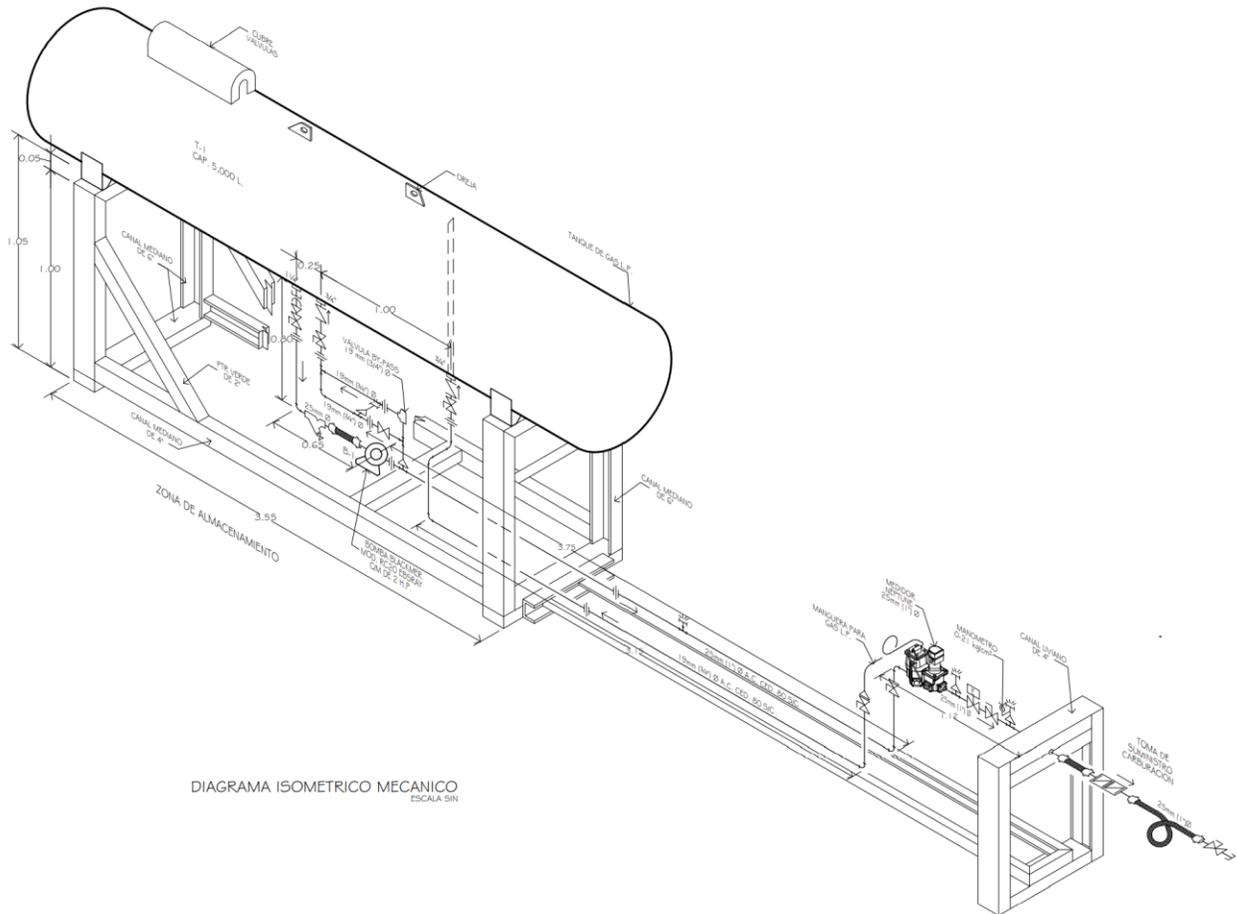
Imagen. Diagrama Isométrico del proyecto de la Estación de Gas L.P. para carburación.
