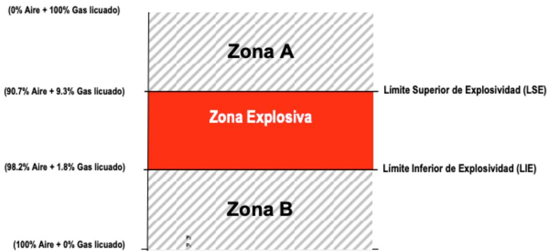
Punto 1 = 20% del LIE.- Valor de ajuste de las alarmas en los detectores de mezclas explosivas.
