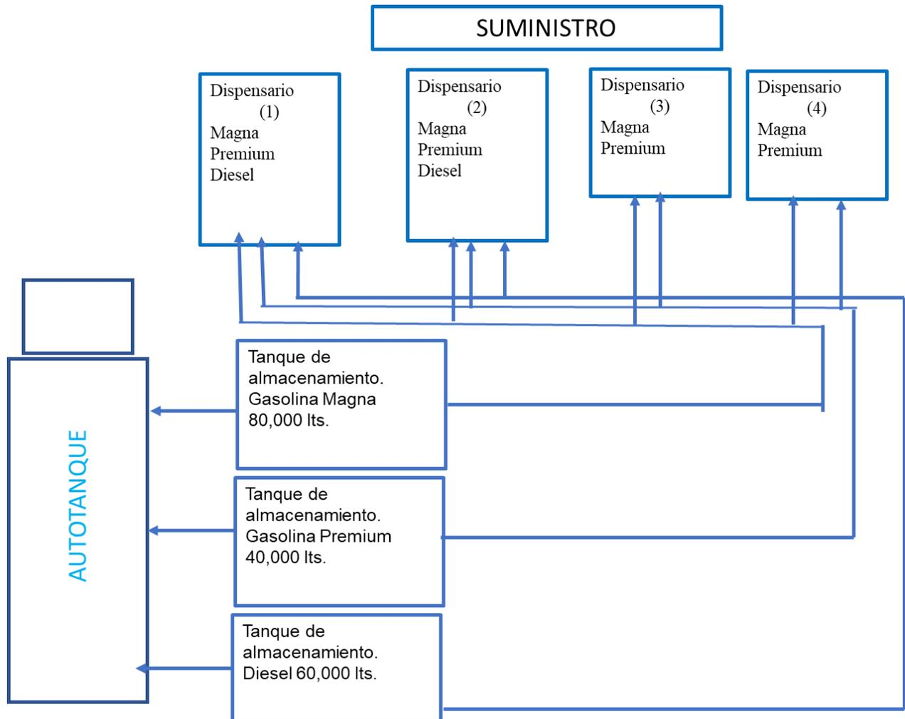
Los combustibles se transportarán en autotanques autorizados por PEMEX, para ser descargados en los tanques de almacenamiento de la Estación de Servicio, por personal autorizado y debidamente capacitado; posteriormente serán suministrados directamente en los tanques de los vehículos automotores.
