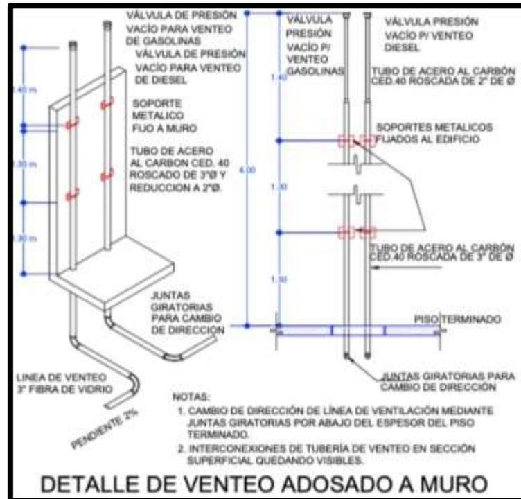
Figura 18. Detalles de la instalación de tubería de venteo.
