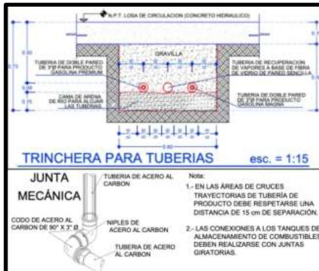
Figura 9. Detalles de la instalación de tubería en trincheras.
