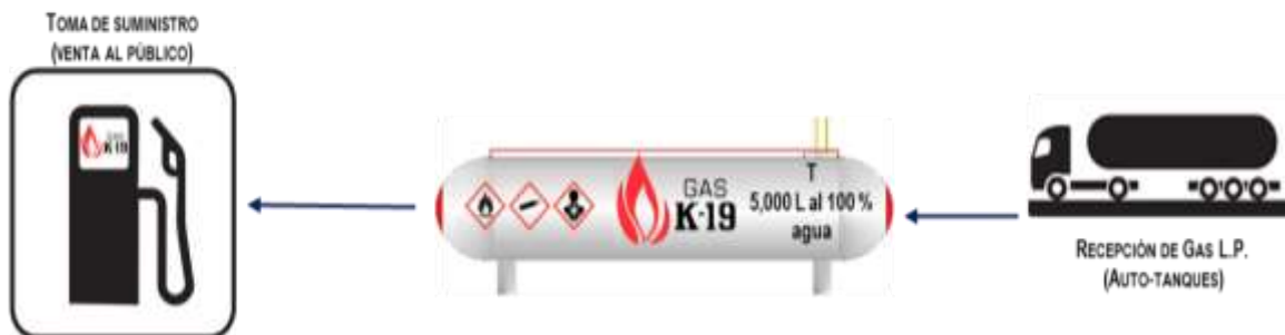
Figura V.9. Diagrama de bloques para la estación de carburación.
