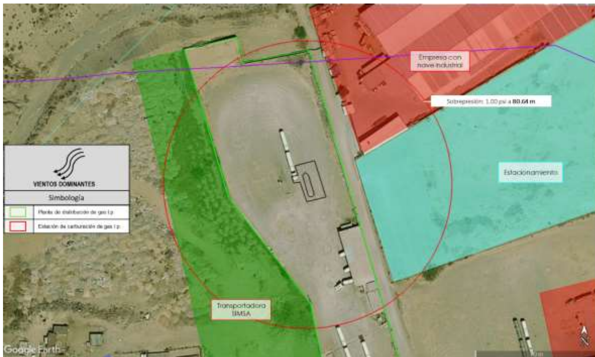
Figura VI.9. Zonas de Alto Riesgo debido a la onda de sobrepresión causada por la explosión del tanque con capacidad de 126.800 m 3 cada uno a causa de la expansión del vapor contenido en este.
