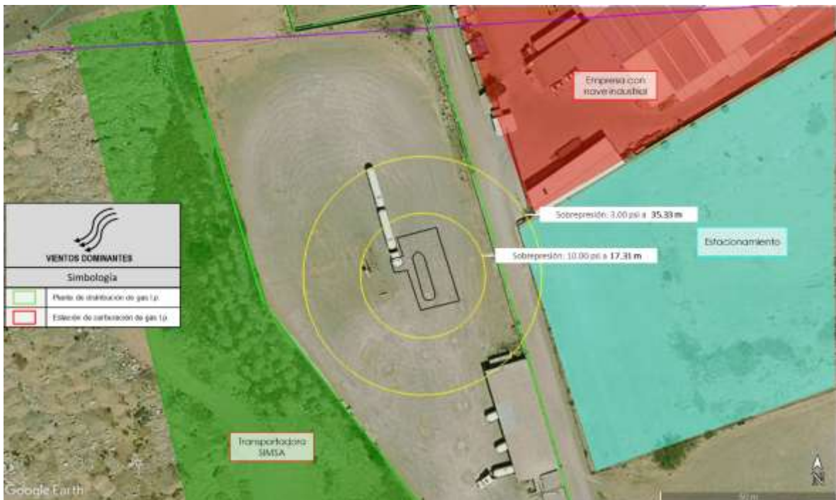
Figura VI.7. Zonas de Alto Riesgo por daño a equipos debido a la onda de sobrepresión causada por la explosión del tanque con capacidad de 126.800 m³ a causa de la expansión del vapor contenido en este.
