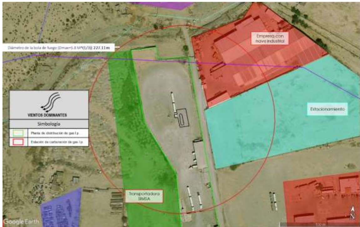
Figura VI.10. Máximo diámetro de la Bola de Fuego originada por la BLEVE de los tres tanques de almacenamiento de gas l.p. con capacidad de 126.800 m 3 .
