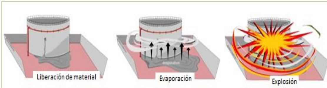
**Figura II.2** Ejemplo de una explosión de nube de vapor (VCE)
