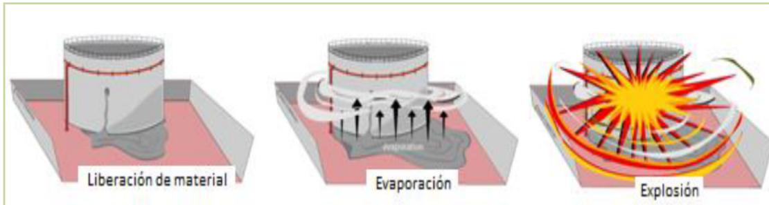
Figura 2.2 Ejemplo de una explosión de nube de vapor (VCE)
