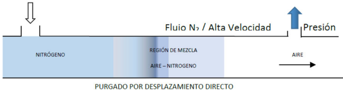
Figura I. 18. Purgado de tuberías por el método de desplazamiento directo
