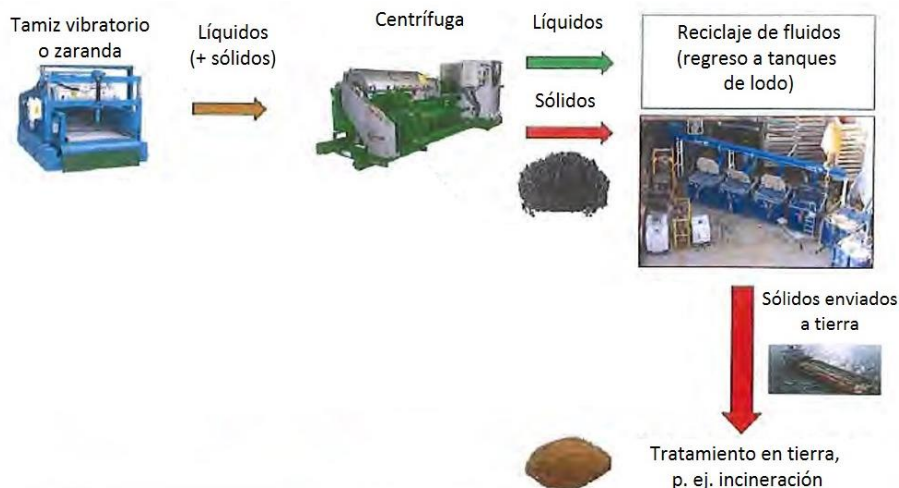
Figura 2-11 Diagrama del sistema de tratamiento para recortes de perforación.
