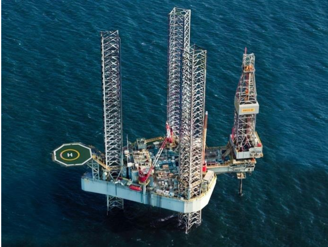
Imagen 2-1 Ejemplo de Jack-up a utilizar en el Proyecto.
