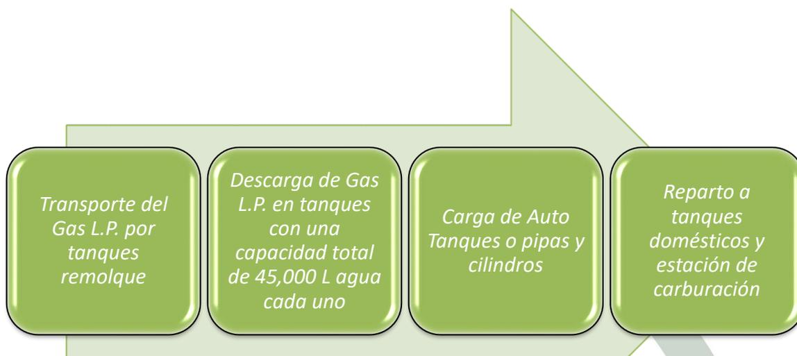
El Gas L. P. es transportado de los centros de almacenamiento de PEMEX, vía terrestre por remolques-tanques a las plantas de distribución en las cuales se trasiega por medio de un compresor a un tanque fijo tipo intemperie cilíndrico horizontal, para su almacenamiento temporal; posteriormente mediante una bomba para transferencia de gas líquido se envía a tomas de carga (auto-tanques).
