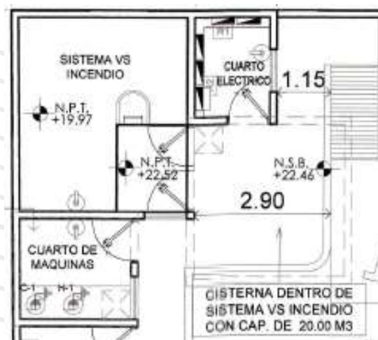
Ilustración 8. Ubicación de cisterna y cuarto de máquinas
