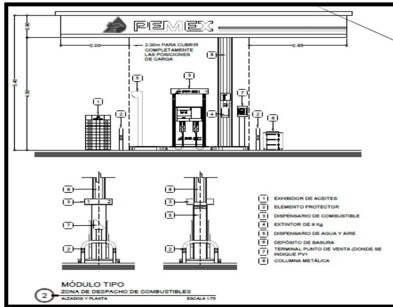
**Imagen 14. Diagrama Tipo del Módulo de Abastecimiento.**
