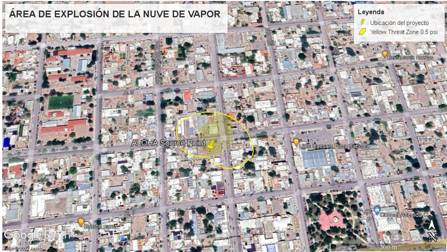
Figura 29. Área de explosión de la nube de vapor
