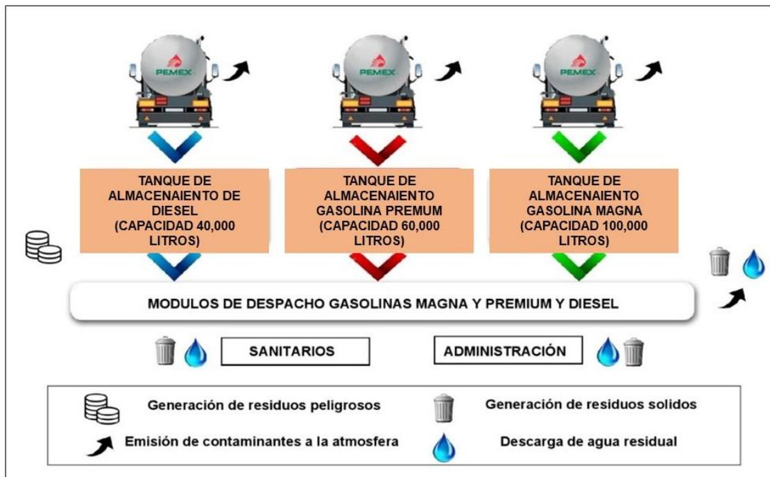
**Imagen 6.** Diagrama de funcionamiento de la Estación de Servicio.
