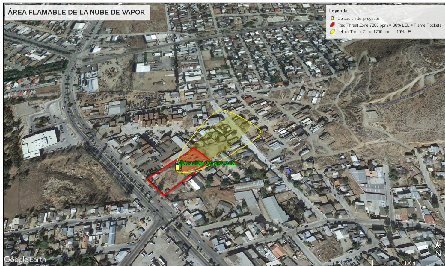
Figura 28. Área flamable de la nube de vapor
