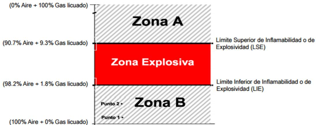
Punto 1 = 20% del LIE: Valor de ajuste de las alarmas en los detectores de mezclas explosivas.
