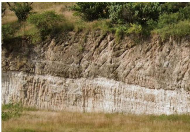
Figura 21. Estratigrafía del sitio, formada por una capa de conglomerado-arenisca, yaciendo sobre material aluvial constituido por arena limosa.
