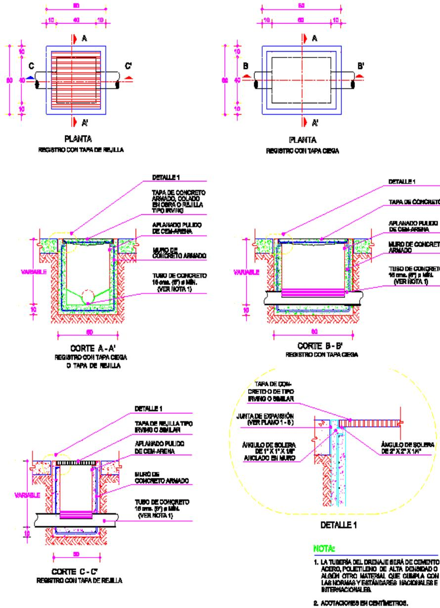
Figura III.4.- Detalle típico para instalación de drenaje.
