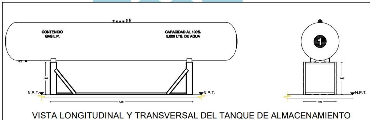
Imagen 9. Vista Longitudinal del Tanque de Almacenamiento.
