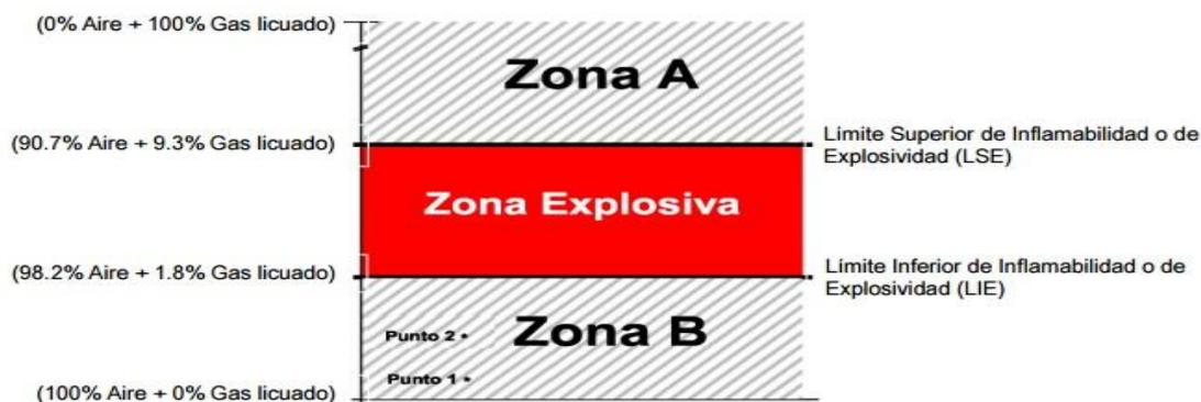
Punto 1 = 20% del LIE: Valor de ajuste de las alarmas en los detectores de mezclas explosivas.
