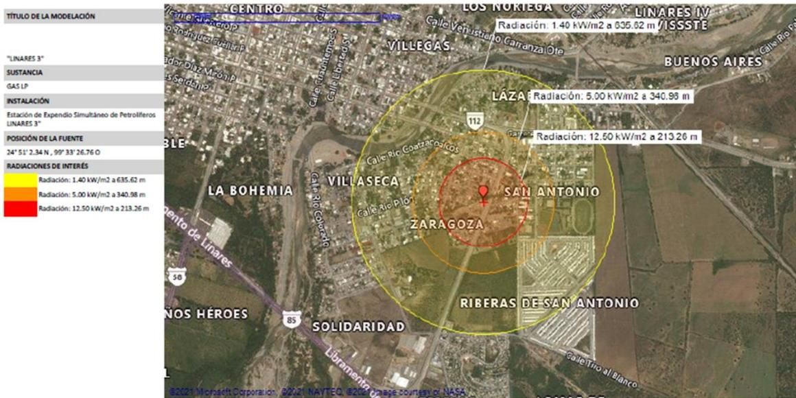
**Ilustración 20.** Radios de afectación en caso de una BLEVE en la *Estación*
