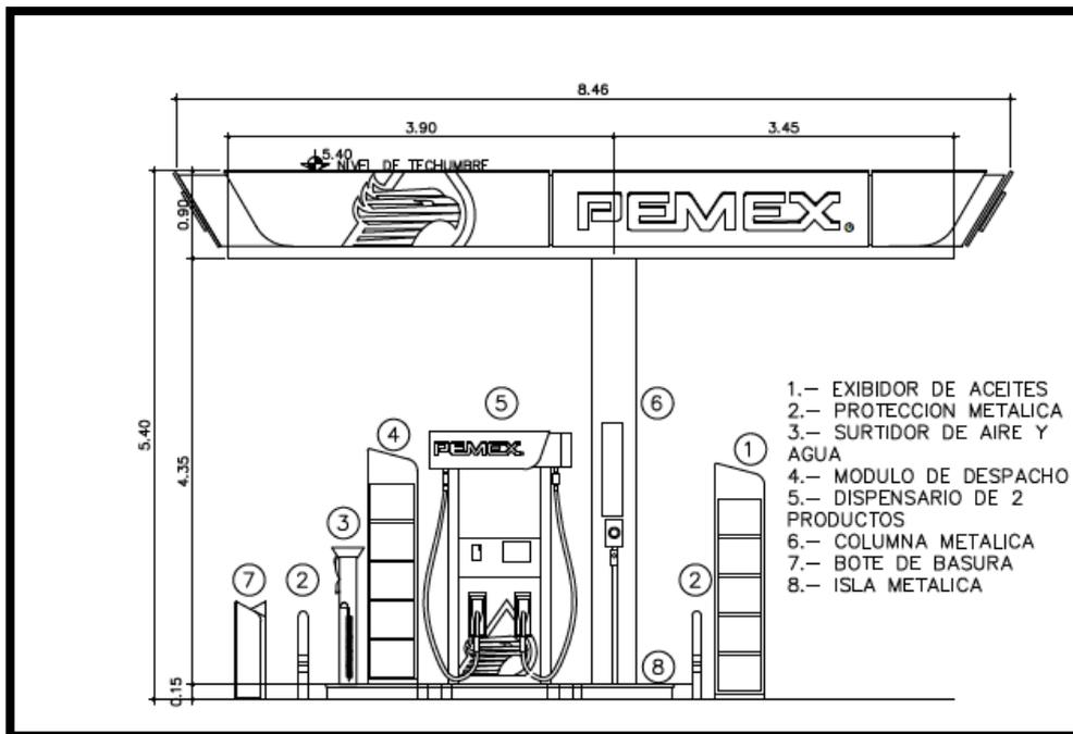
Imagen 10. Diagrama Tipo del Módulo de Abastecimiento.
