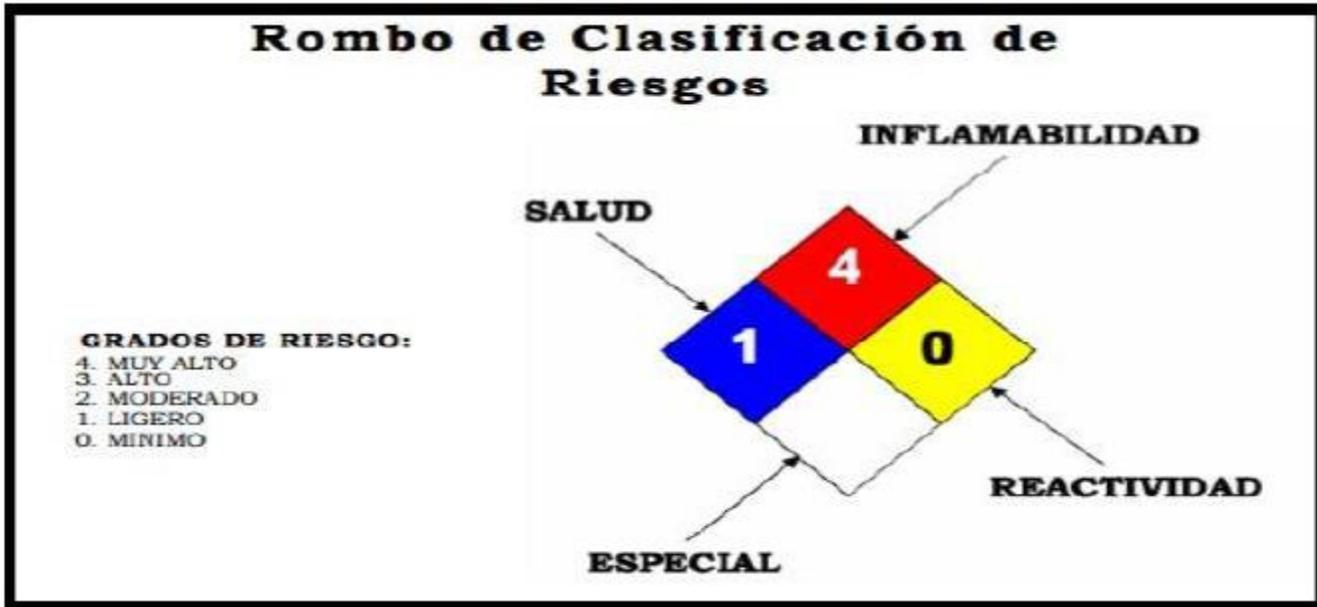
Ilustración 25. Rombo de seguridad para Gas L.P.
