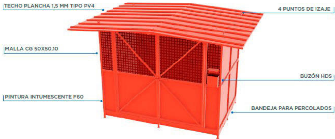
Figura 7. Características del almacén temporal de residuos peligrosos
