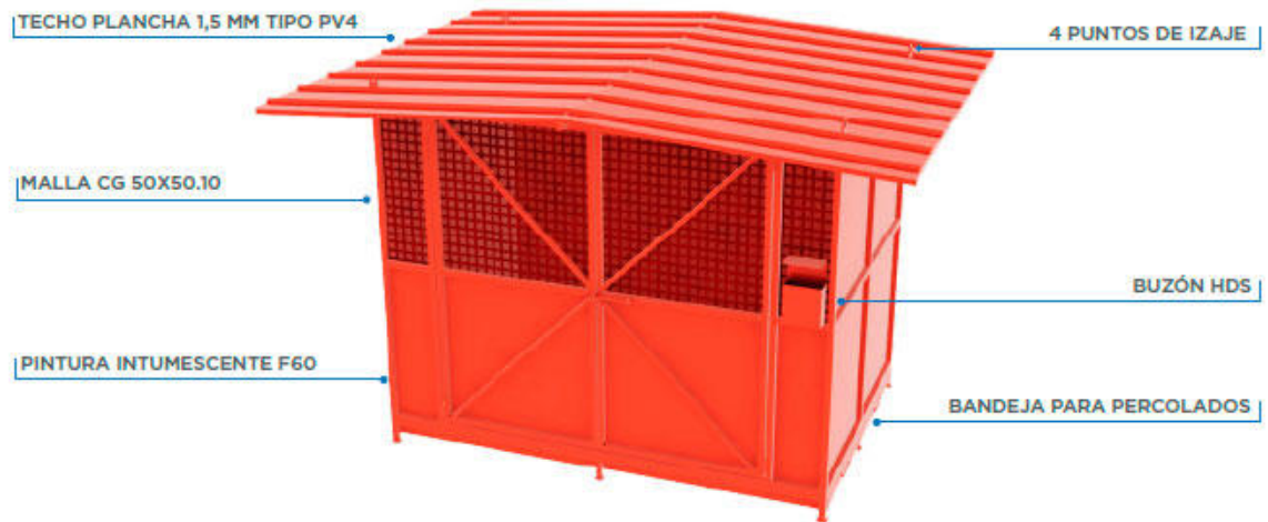
Figura 7. Características del almacén temporal de residuos peligrosos
