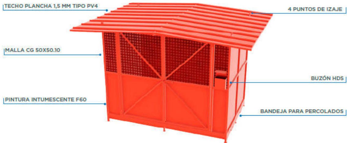
Figura 7. Características del almacén temporal de residuos peligrosos
