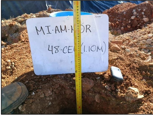
19. Se midieron las profundidades de los puntos de muestreo con un flexómetro.
