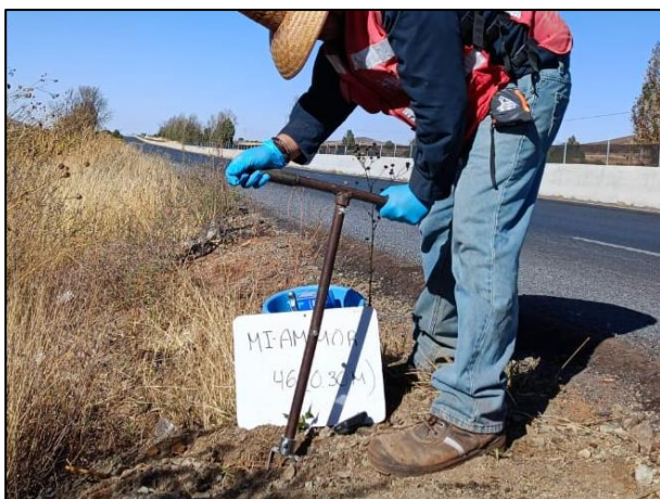
17. Toma de muestras en las periferias de las Fosas de Excavación.
