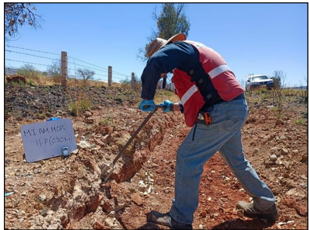
04. Se realizó la toma de muestras de acuerdo con el Plan de Muestreo. Toma de muestra en pared de la Fosa de Excavación "A".
