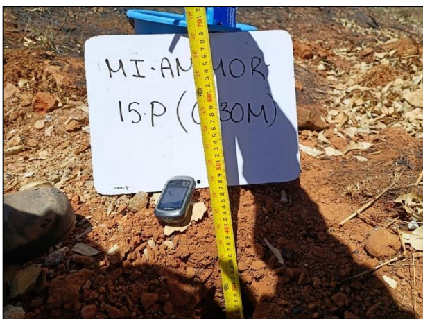
05. Se realizó la medición de las profundidades con un flexómetro en los puntos de muestreo.
