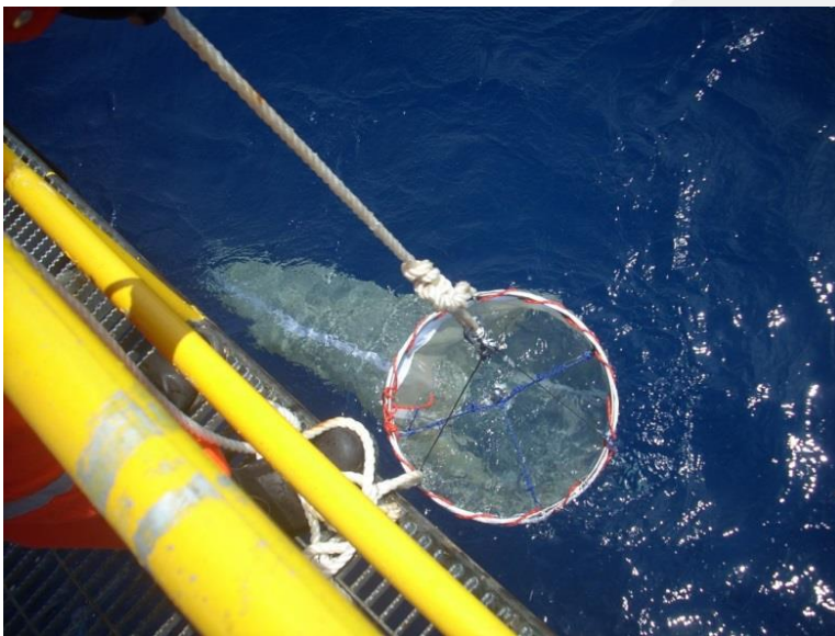
Figura 9-20. Red CalCOFI de 333 \mu\text{m} de abertura de malla con flujómetro
