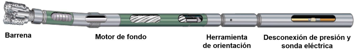
Figura 1-20. Arreglo de pozo.
