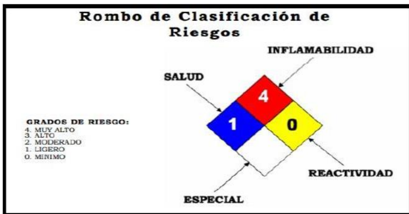
Ilustración 21. Rombo de seguridad para Gas L.P.
