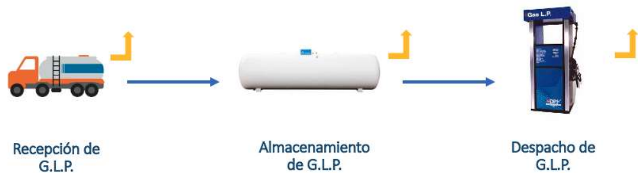
Figura 10. Emisiones fugitivas de Gas Licuado de Petróleo durante la operación del proyecto.
