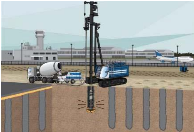
Figura 3.5 Diagrama de colocación de inclusiones
