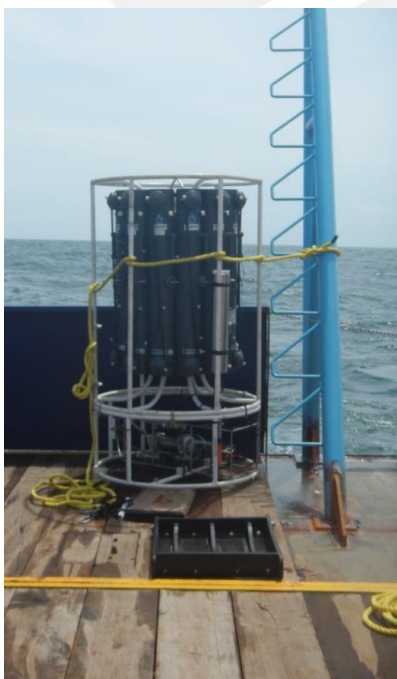
Figura 4-20 Roseta de botellas Niskin utilizada en el muestreo de agua
