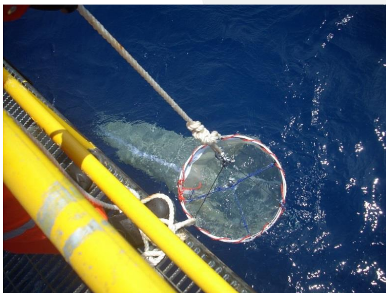
Figura 4-28 Red CalCOFI de 333 \mu\text{m} de abertura de malla con flujómetro
