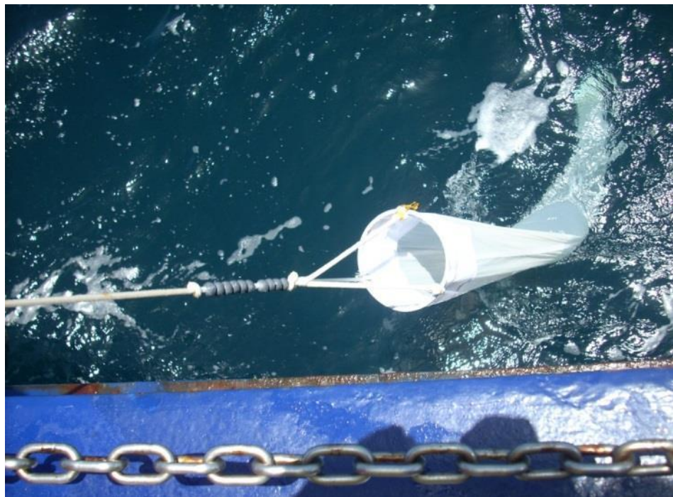
Figura 4-27 Red estándar de 20 µm empleada para la colecta de muestras de fitoplancton
