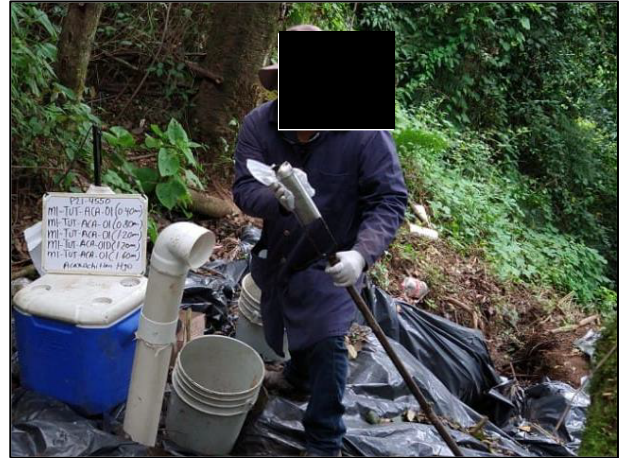
02. El equipo de muestreo fue lavado al inicio de la toma de muestras, así como entre cada toma de estas, con ello evitando la contaminación cruzada.
