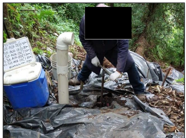
06. Se utilizó Hand Auger de acero inoxidable para la toma de muestras a diferentes profundidades dentro del Área Afectada.
