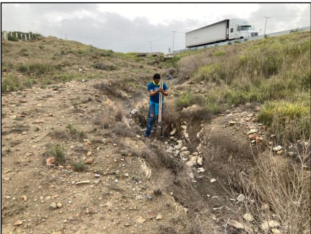
21. Se realizaron sondeos en el sitio afectado con apoyo de pocera (Fosa de Excavación "A").
