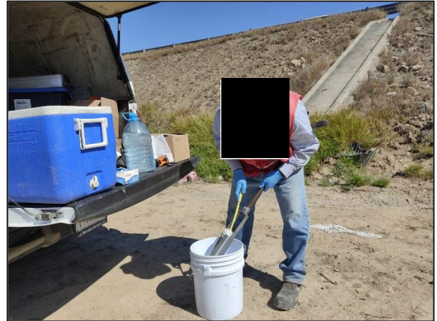
02. El equipo de muestreo fue lavado al inicio de la toma de muestras, así como entre cada toma de estas.
