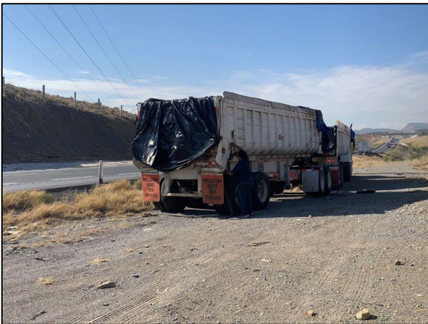
15. Para llevar a cabo la disposición del material contaminado (basura y escombros) se acondicionó la unidad de transporte con película de polietileno de alta densidad.
