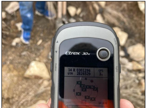
24. Con apoyo de GPS se realizó el levantamiento de coordenadas.
