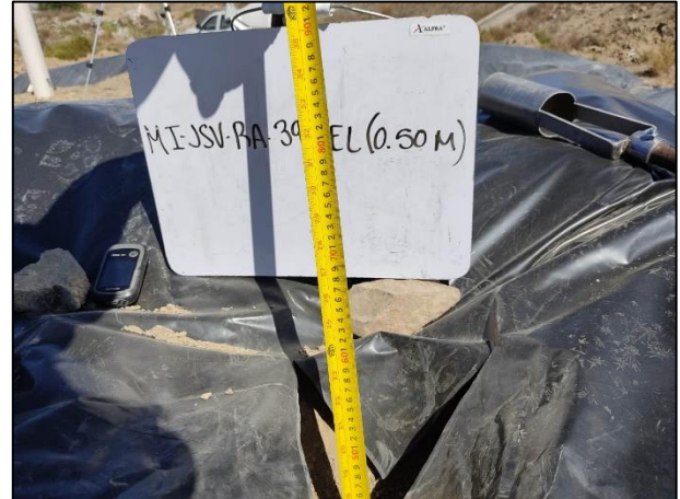
16. Con apoyo del flexómetro se tomaron las profundidades de los puntos de muestreo.
