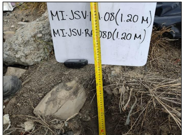
06. Con apoyo del flexómetro se realizó la medición de las profundidades en los puntos de muestreo.
