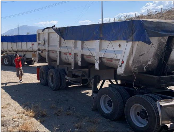
19. Las unidades de transporte fueron cubiertas a fin de evitar la emisión de Compuestos Orgánicos Volátiles (COV's).
