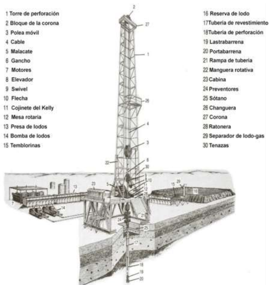
Figura V.2-2. Conformación de un equipo de perforación.
