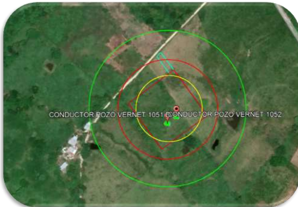
Figura IV.4-2 ZAR y ZA por sobrepresión del escenario ER-P-PP-ACCS01-PC-01 (Brote del pozo/descarga de aceite) en el Pozo Vernet 1052
