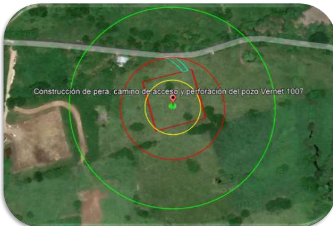
Figura V.5-1 ZAR´s por radiación del escenario 1 (ER-P-PP-ACCS01-PC-01) correspondiente a Brote del pozo con descarga de aceite y gas.)
