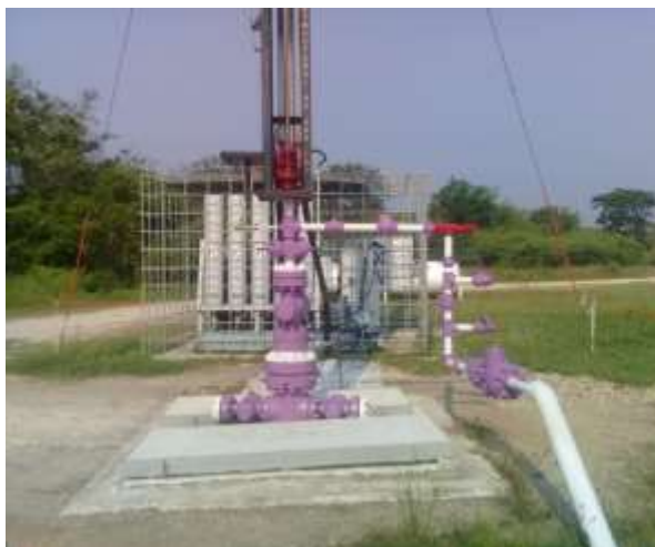
Figura V.1-17. Vista típica de un bombeo mecánico accionado hidráulicamente
