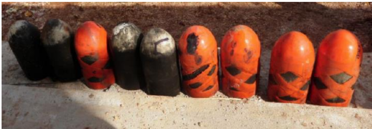
Figura X.100. Fotografía ilustrativa de diablos de limpieza Fuente: propiedad de Gas Natural Potosino
