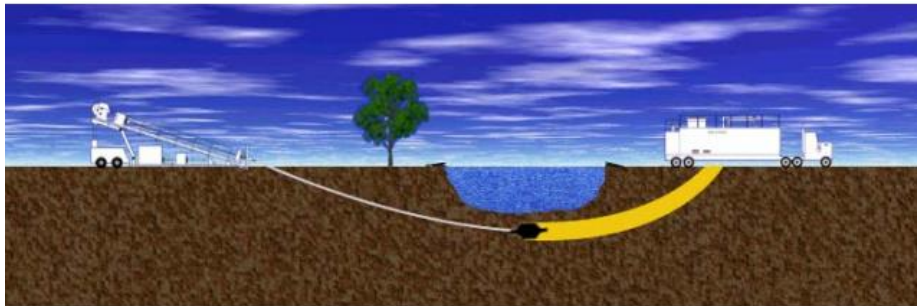
FIGURA 32. REPRESENTACIÓN DE LA AMPLIACIÓN DE LA PERFORACIÓN PILOTO.
