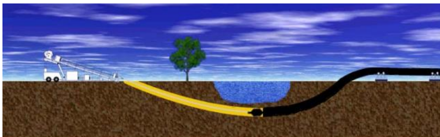
FIGURA 33. REPRESENTACIÓN DE CÓMO LA TUBERÍA ES JALADA PARA LLEGAR AL EXTREMO OPUESTO.
