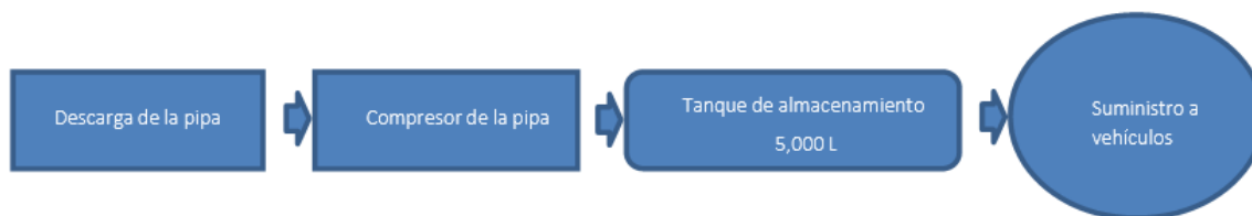
Figura 8. Diagrama de flujo de la estación de carburación del Proyecto
